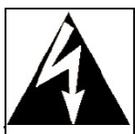
Этот знак предупреждает пользователя об опасности высокого напряжения внутри устройства.
